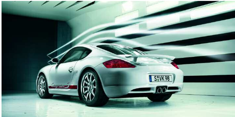
Cayman S mit Aerokit im Windkanal
